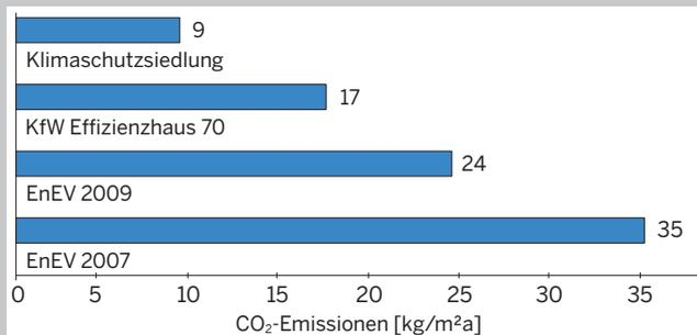
Vergleich der CO<sub>2</sub>-Emissionen für eine Doppelhaushälfte (Neubau) bei unterschiedlichen Gebäudestandards
