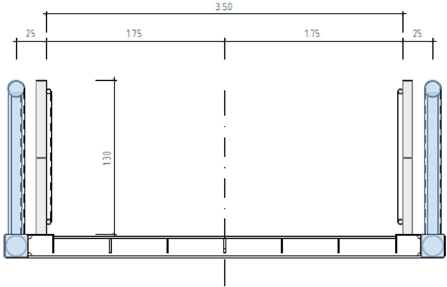
An dem vorhandenen Bauwerk 17 (Länge: ~ 13,00 m, lichte Breite: 3,20 m) wurden 2016 bei einer durchgeführten Hauptprüfung statisch relevante Mängel, in den unterschiedlichen Bereichen des Bauwerkes, festgestellt. Aufgrund einer Wirtschaftlichkeitsbetrachtung soll eine komplette Erneuerung des Überbaues erfolgen. Die Entscheidung über eine Erneuerung oder Sanierung der Fundamente steht noch aus.
