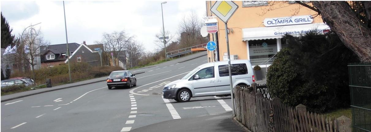
Gegebenenfalls kann das Ende der Radwegmarkierung auch noch weiter in Richtung Westen (auf dem Bild nach links) verlegt werden, wozu allerdings die Bordsteinabsenkung auch an der Ecke notwendig würde.
