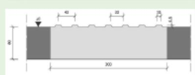
Bild 1: Querschnitt Rippenplatte für Richtungs- und Sperrfeld (beispielhaft)
