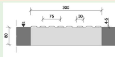
Bild 3: Querschnitt Noppenplatte (beispielhaft)
